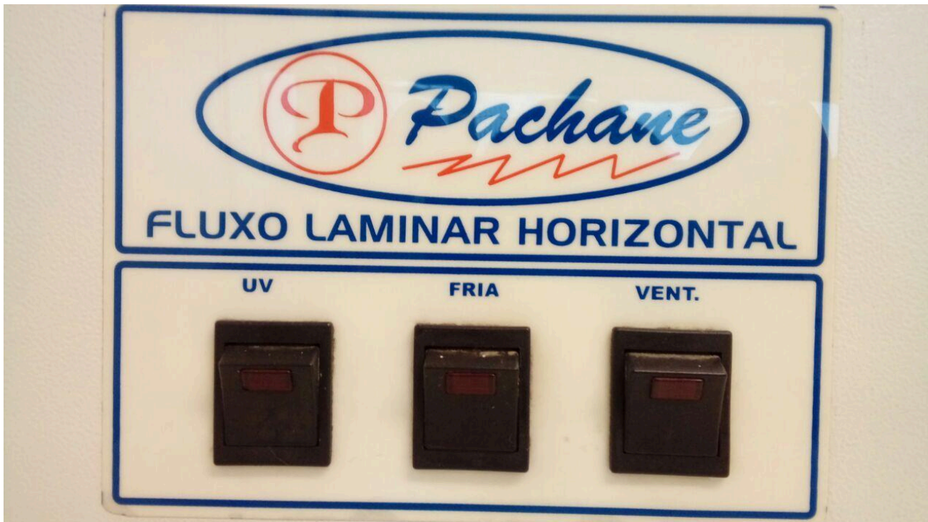
Figura 1: Painel de controle da cabine de segurança biológica.
